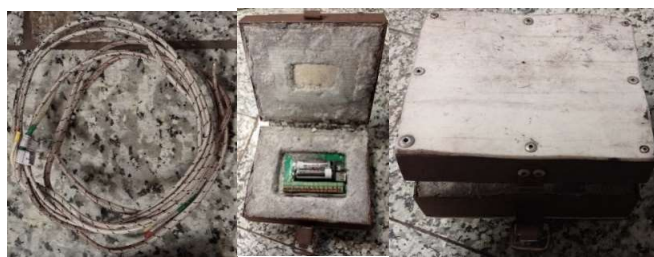
Рисунок 4.4 – Составляющие измерительного прибора термолотгер
