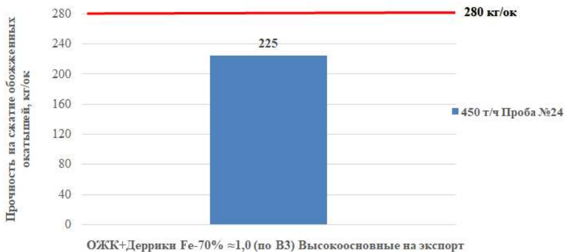
Рисунок 4.20 – Прочность на сжатие обожженных окатышей ОЖК пробы №24 (таблица 4.1)
