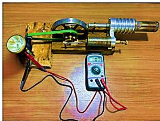
Рис. 20: Установка измерения выходной электрической мощности
