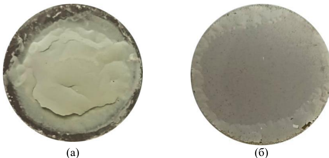
Рисунок 13 – Оптические фотографии: (а) - слой YSZ-disp на поверхности подложки SDC после спекания при температуре 1400 \text{ }^\circ\text{C} , 5 ч; (б) - слой YSZ-L на поверхности подложки SDC после спекания при температуре 1300 \text{ }^\circ\text{C} , 5 ч
