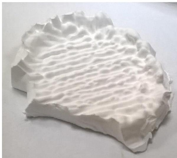
Рисунок 3.33 – Изображение объемного образца YSZ, полученного при ЭФО в ячейке с плоским противозэлектродом при напряжении 100 В
