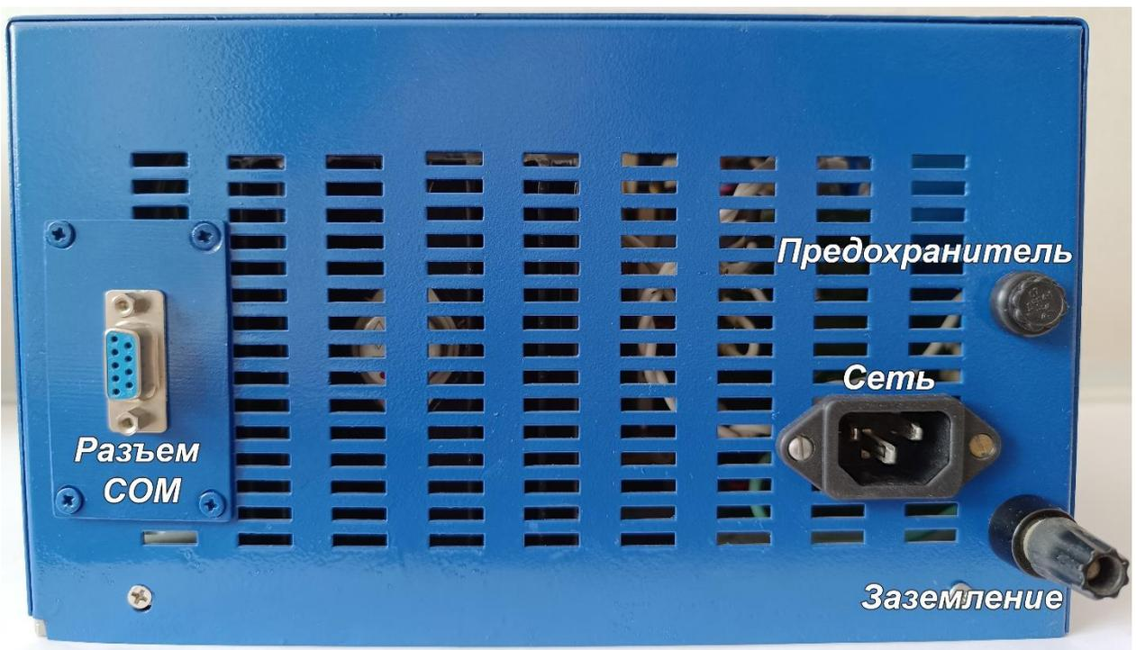
Рисунок 2.4 – Обратная сторона электронного блока питания
