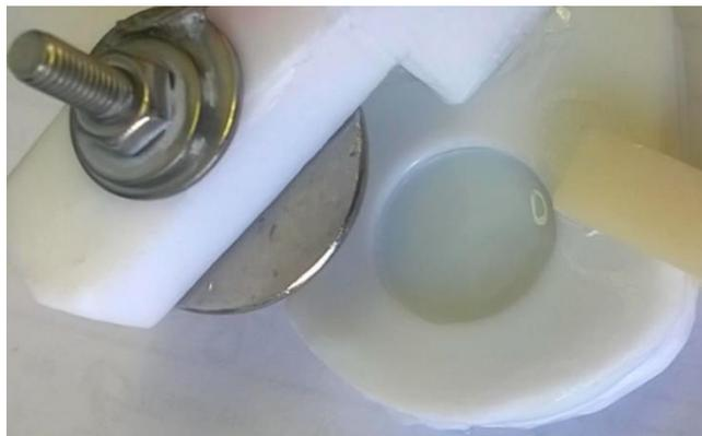
**Рисунок 1.13** – Изображение ячейки с горизонтальным расположением электродов и осаждением на нижний электрод [140]
