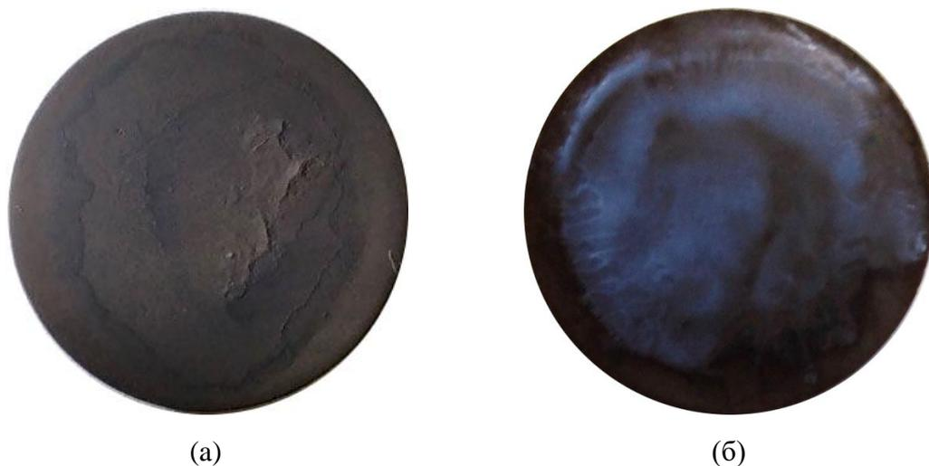
**Рисунок 7.19** – Оптические фотографии покрытия, полученного прямым ЭФО на пористой анодной подложке NiO-SDC (пористость 26-28 %) при осаждении из суспензий: (а) BCZYbO<sub>2</sub>-CuO; (б) SDC
