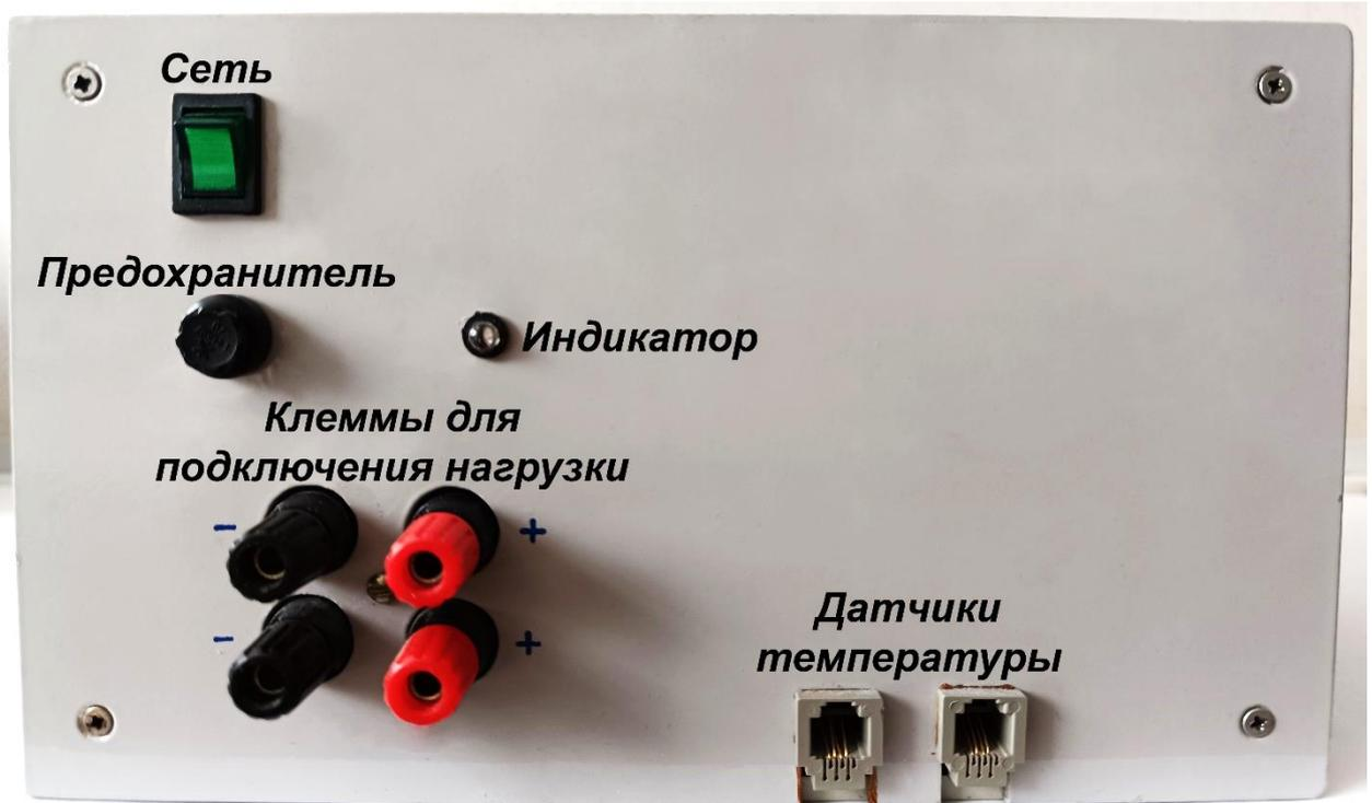
Рисунок 2.3 – Лицевая панель электронного блока питания
