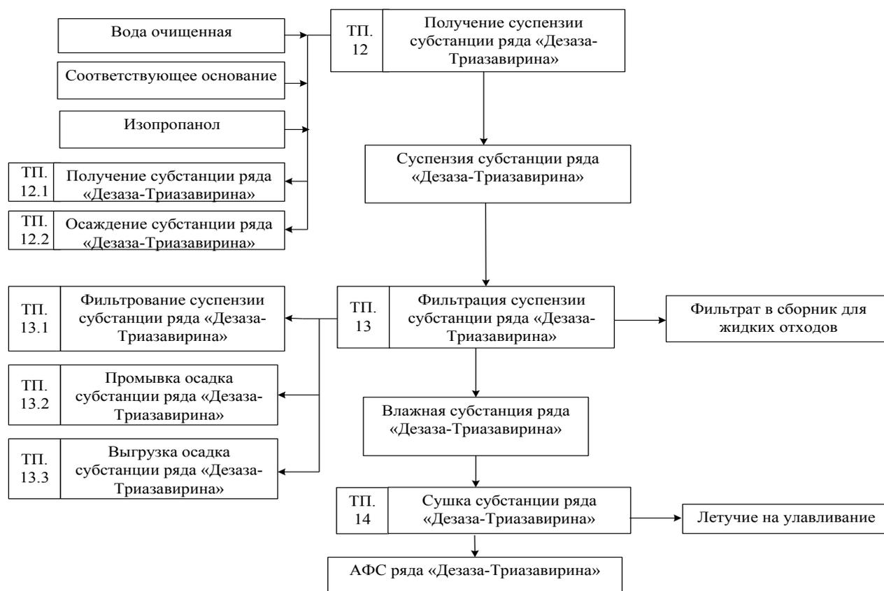
**Рисунок 7** – Технологическая схема стадий ТП.12 – ТП.14
