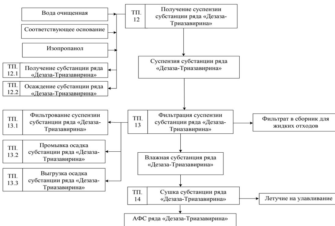
**Рисунок 2.4.8** – Технологическая схема стадий ТП.12 – ТП.14
