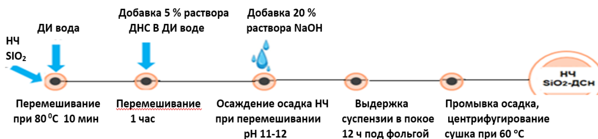
Рисунок 12 – Схема химического синтеза НЧ SiO 2 -ДСН
