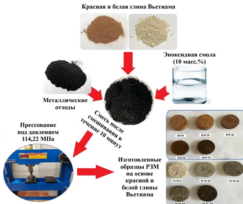
Рис. 17. Технология изготовления образцов РЗМ на основе красной и белой глины Вьетнама с наполнителем в виде промышленных металлических отходов
