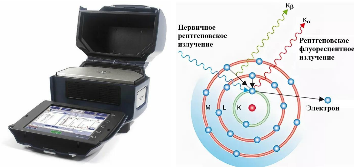
Рисунок 2.4. Анализатор Olympus X-5000 для определения химического состава образцов с помощью метода рентгенофлуоресцентного анализа и его принцип работы
