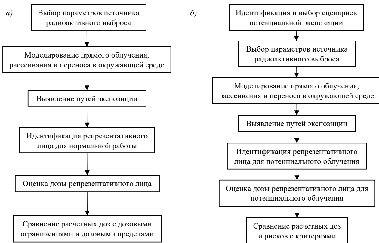
Рисунок 5.8. Компоненты оценки радиологического воздействия на окружающую среду для защиты населения при нормальной эксплуатации (а), и оценки для рассмотрения потенциального облучения (б) [118]
