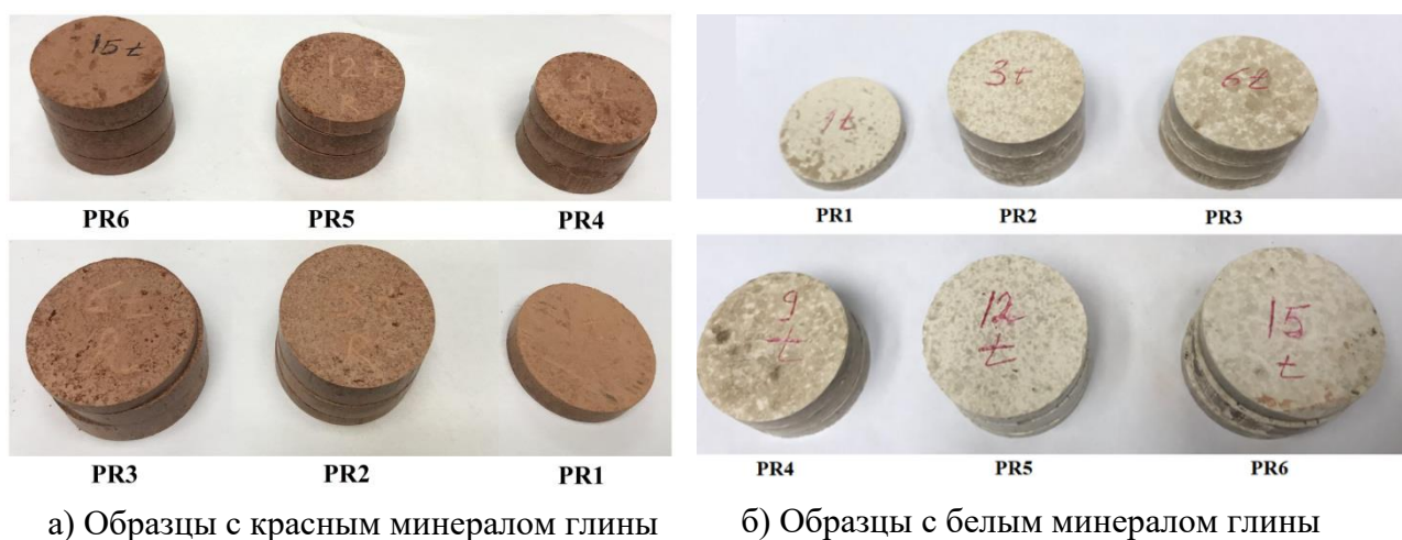
Рисунок 3.1. Изготовленные образцы прессованного кирпича при разном давлении от 1 до 15 тонн (эквивалентно от 7,61 до 114,22 МПа)
