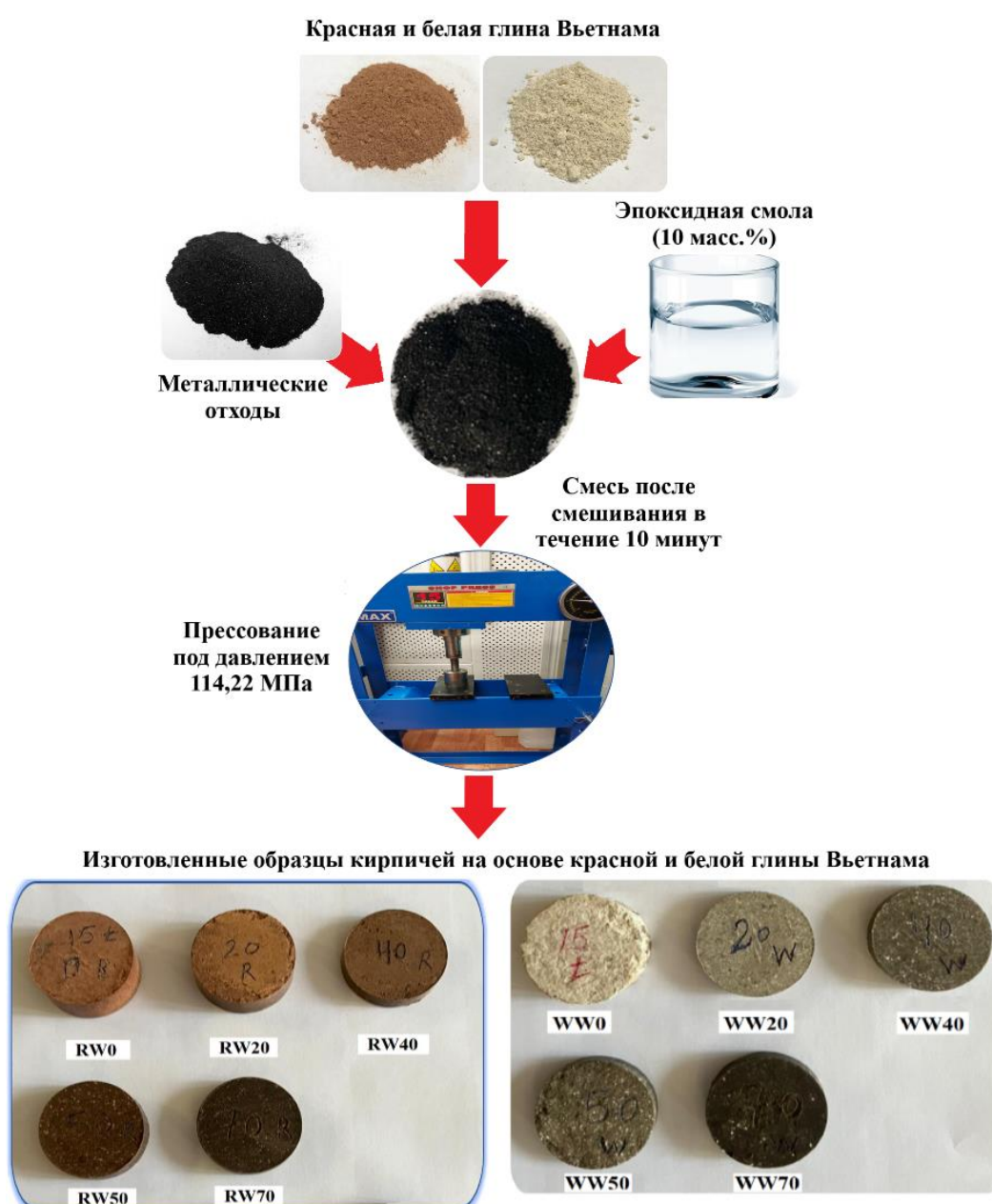
Рисунок 4.1. Технологическая схема процессов изготовления образцов РЗМ на основе красной и белой глины Вьетнама с добавкой промышленных металлических отходов
