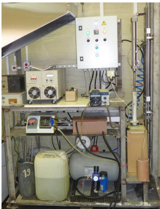
Рисунок 34 – Общий вид установки электроэкстракции цинка
