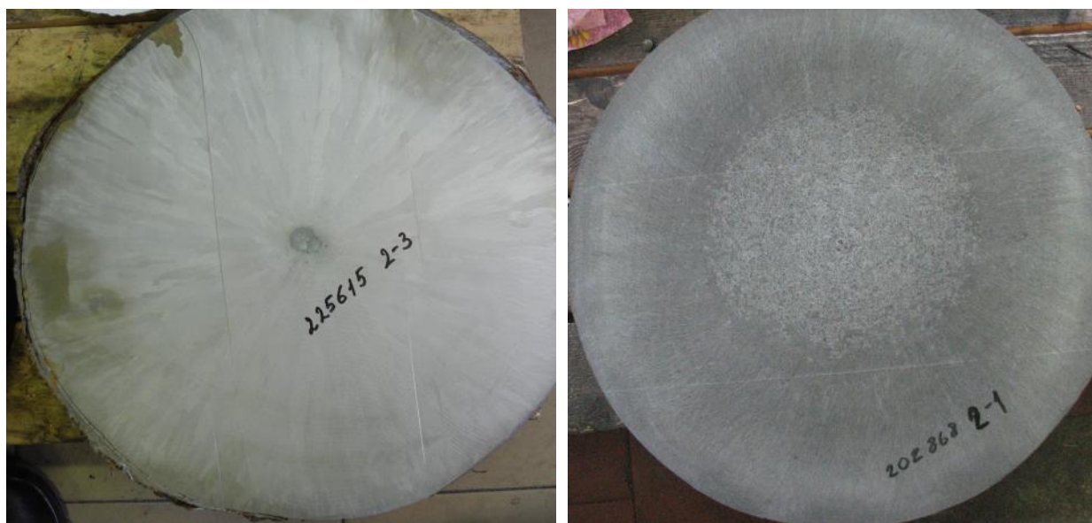
Рисунок 6.2 Характерный вид макроструктуры НЛЗ диаметром 340 мм до реконструкции (слева) и после нее (справа)
