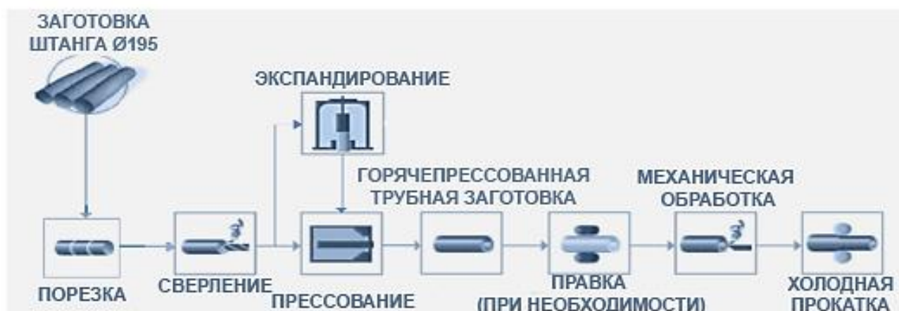
Рисунок 5.1. Сквозная схема производства труб TREX [148]
