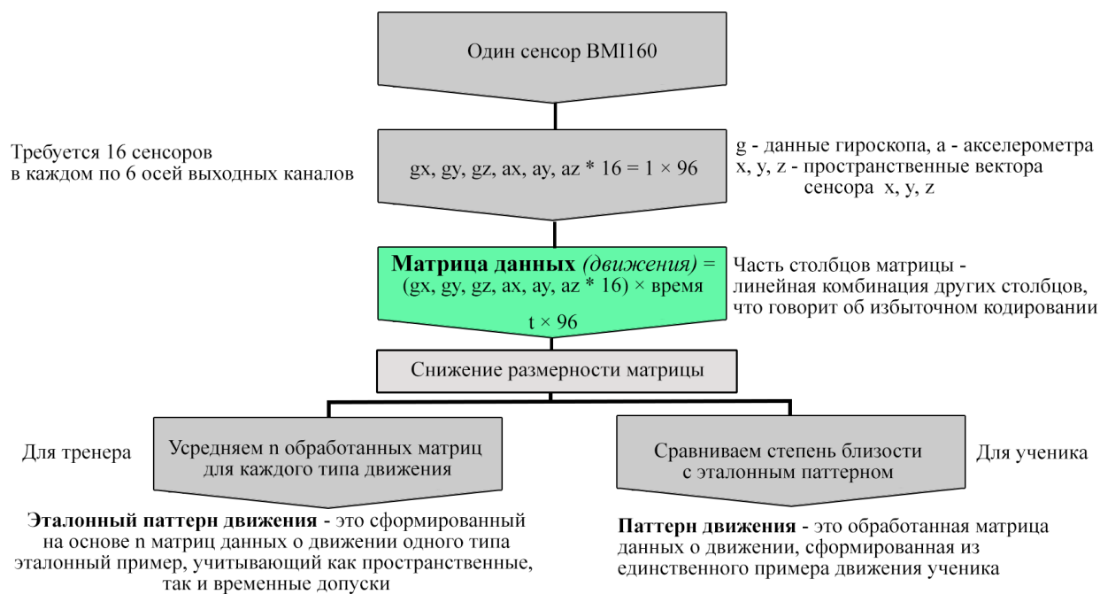
Рисунок 2.16 – Способы формирования цифровых паттернов движения: эталонные и исследуемый
