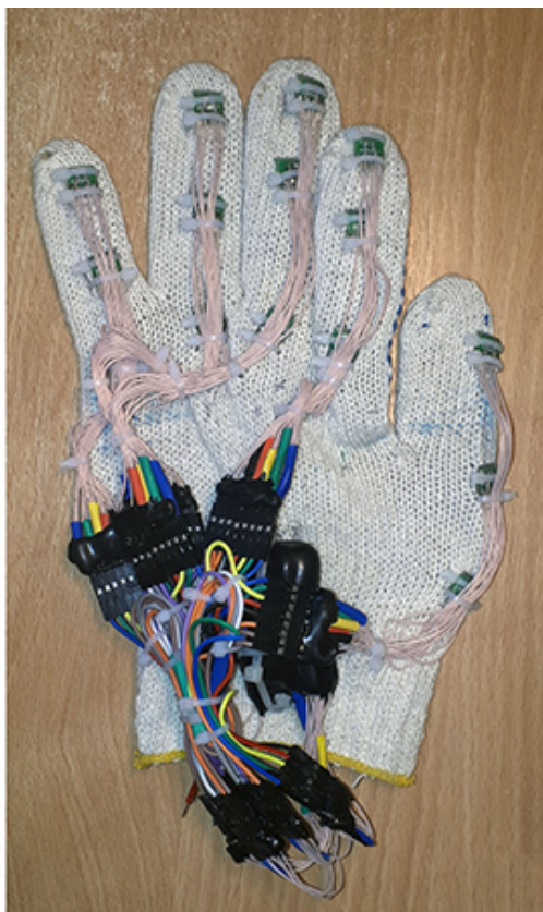
Рисунок 5.11 – Реализация программно-аппаратного комплекса в виде перчатки.
