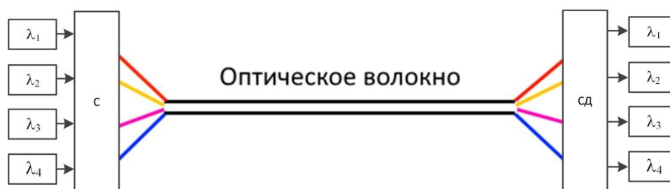
Рисунок 3.1 – Принцип параллельной передачи сигналов с разделением излучения по длине волны.
