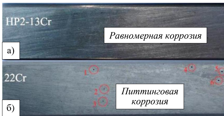
Рисунок 1.11 – Поверхность образцов из сталей мартенситного (а) и аустенитно-ферритного (б) классов [77]
