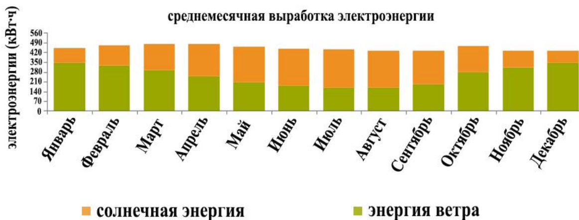
Рисунок 7 – Среднемесячное производство электроэнергии гибридной ветро-фотоэлектрической системой.
