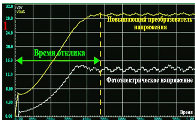
Рисунок 5 – Сравнительные экспериментальные результаты напряжений фотоэлектрического модуля и повышающего преобразователя для: 1 - традиционного алгоритма, 2-модифицированного алгоритма.
