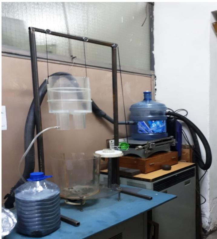
Рисунок 12 – Лабораторная установка циркуляционного вакуумирования
