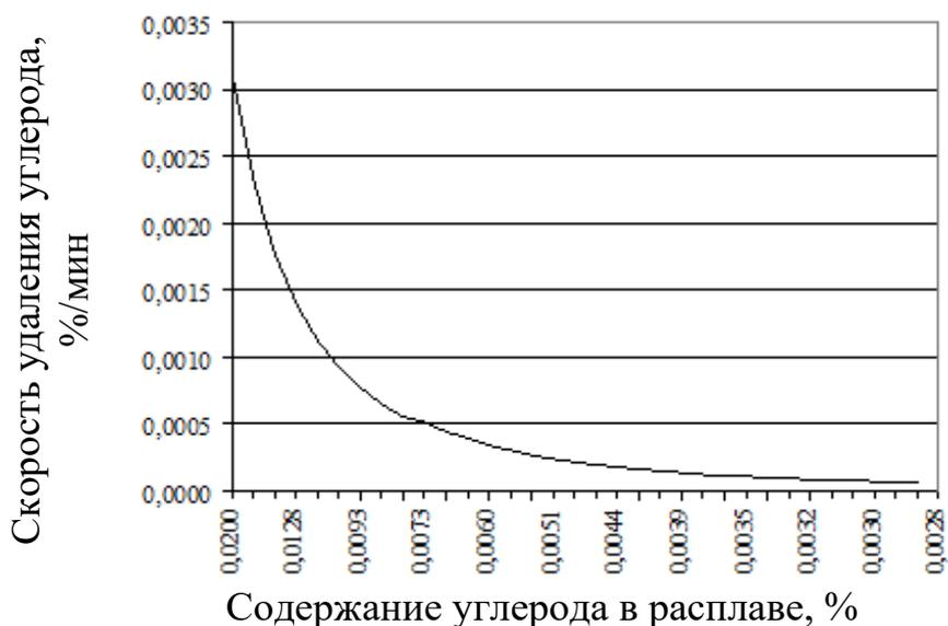
Рисунок 11 – Удаление углерода из расплава путем образования газа {CO} с последующим его всплытием и удалением из металла
