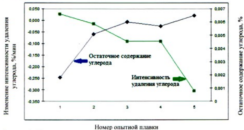
Рисунок 4 – Сопоставление интенсивности удаления углерода с остаточным содержанием данного элемента в расплаве после вакуумирования
