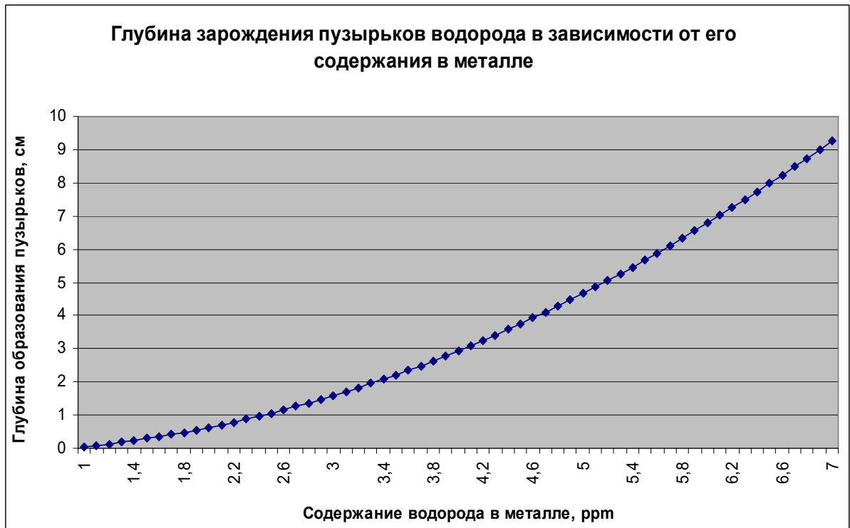
Рисунок 3.3 – Глубина зарождения пузырьков водорода в зависимости от его содержания в металле
