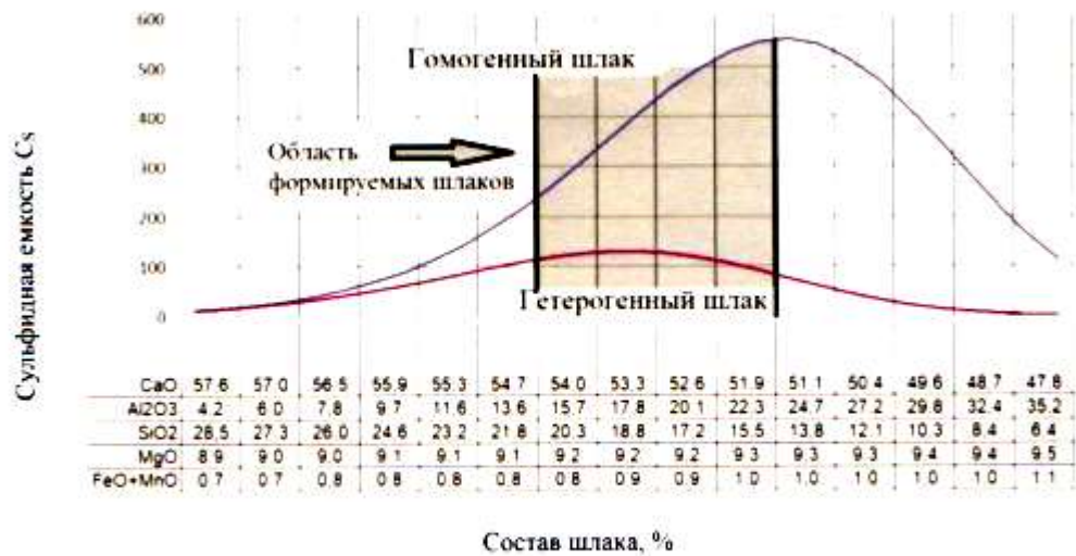
Рисунок 2 – Сульфидная емкость шлаков в зависимости от его химического состава
