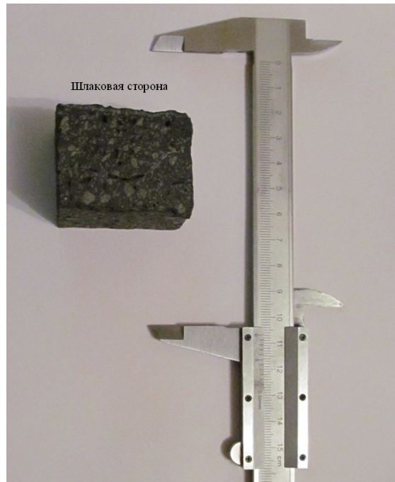
Рисунок 2.30 – Исследуемое алюмопериклазоуглеродистое огнеупорное изделие после службы
