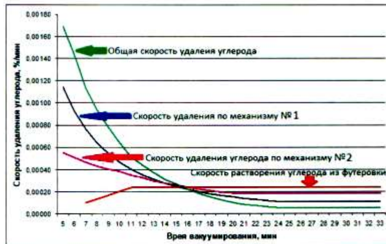
Рисунок 2 – Скорость удаления и растворения углерода в металле во время обработки в циркуляционном вакууматоре
