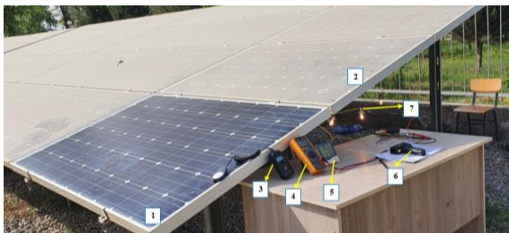
Рисунок 7 – Экспериментальная установка для определения генерации в условиях г. Бохтар
