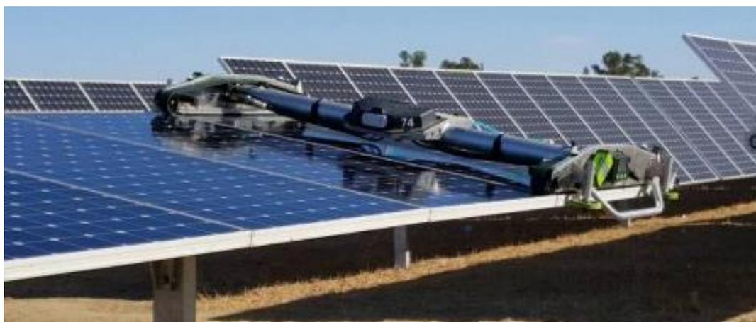
Рисунок 1.9 – Автоматизированная система очистки панелей, содержащая защитный корпус и очистительные щетки
