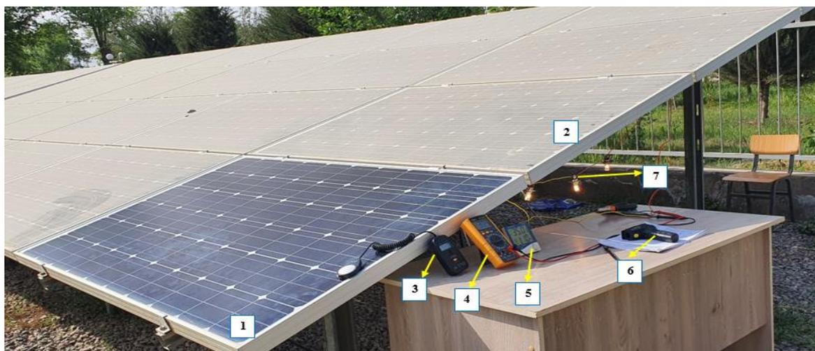
Рисунок 4.1 – Экспериментальная установка для определения генерации в условиях г. Бохтар (1 – очищенный солнечный модуль; 2 – запыленный солнечный модуль; 3 – цифровой люксметр MS6610; 4 – цифровой мультиметр CHYVictorVC890D; 5 – термометр/гигрометр TH90; 6 – инфракрасный термометр IR01D; 7 – галогенные лампы)
