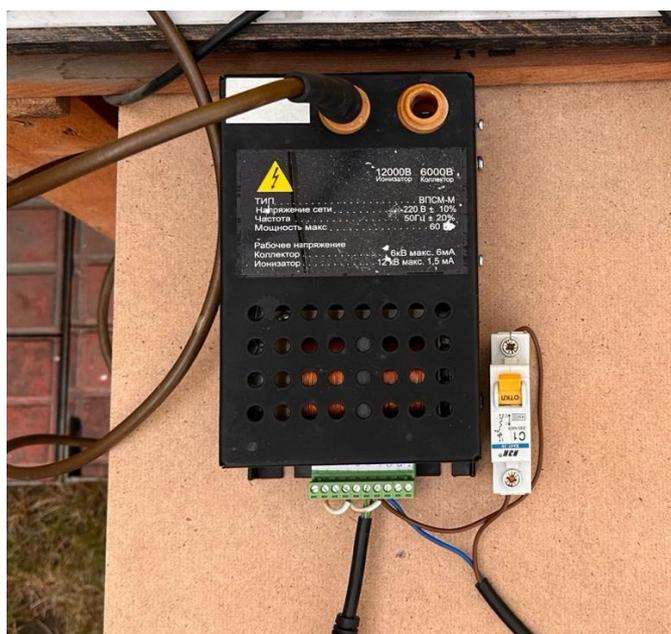
Рисунок 4.6 – Источник высокого напряжения
