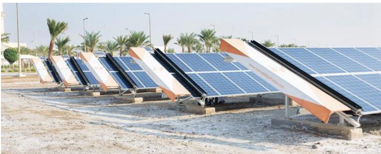
Рисунок 1.11 – Роботизированная установка NOMADD (Саудовская Аравия)
