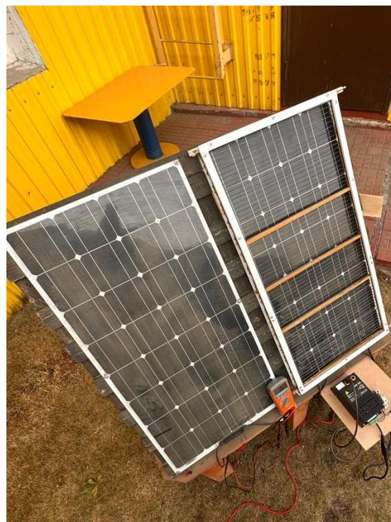
Рисунок П.6.8 – Запыление панелей
