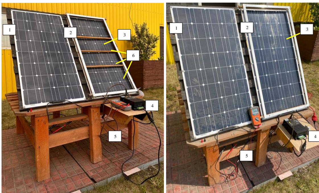
Рисунок 4.5 – Общий вид экспериментальной установки: слева – горизонтальная ориентация устройства, справа – вертикальная ориентация устройства (1 – запыленная солнечная панель, 2 – очищаемая устройством солнечная панель, 3 – УПЗ, 4 – источник высокого напряжения ВПСМ-М, 5 – цифровой мультиметр APPA 62, 6 – распорки из текстолита)
