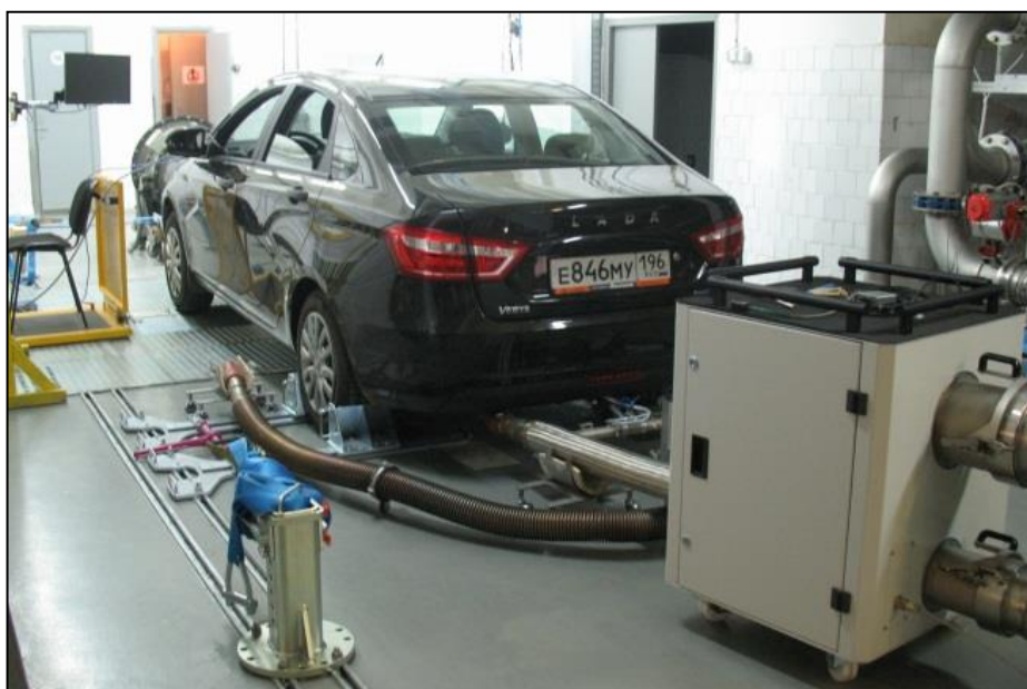
Рисунок 5.2 – Автомобиль Lada Vesta 1.6 л во время испытаний каталитического блока в составе ТПГНС на роликовом стенде AP500 SCHENCK
