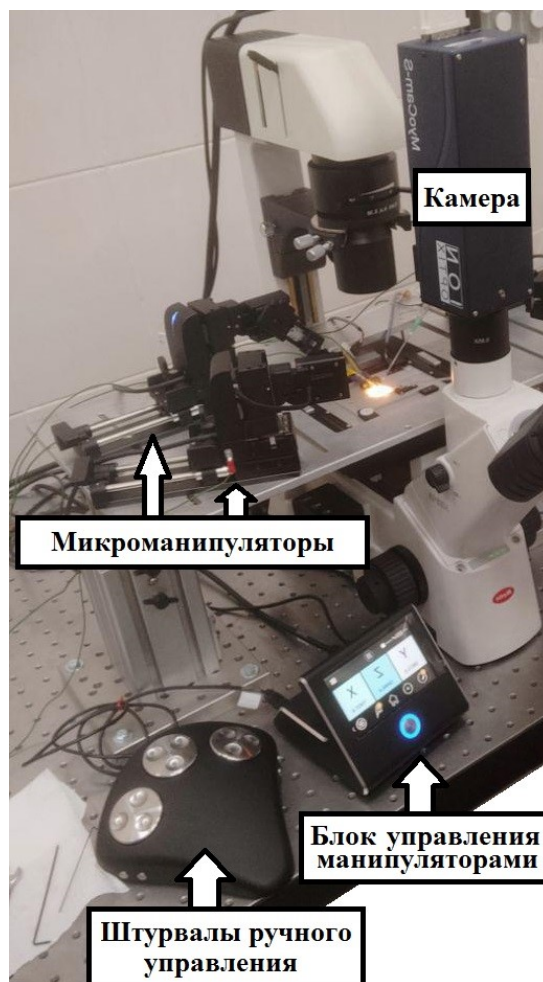
Рисунок 2.10 – Система цифрового микроманипулирования Sensapex
