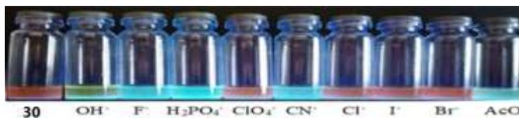
**Рисунок 2.45.** Изменение флуоресценции полимочевины **30** в присутствии различных анионов, а также гидроксид-аниона
