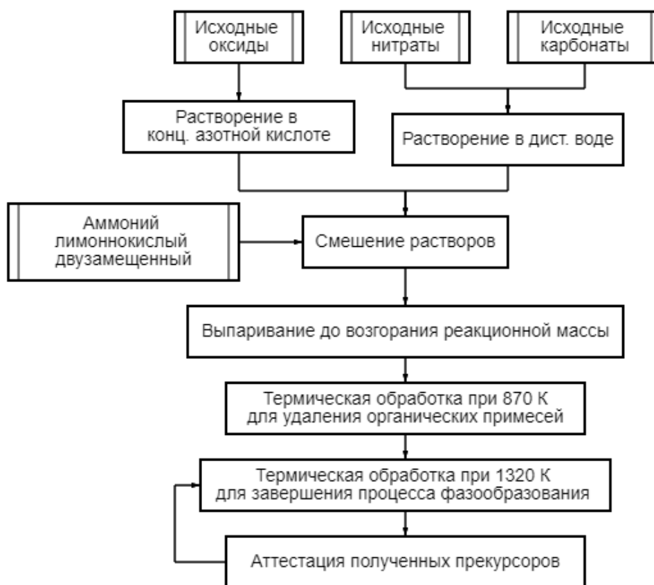
Рисунок 3.1 – Принципиальная схема получения порошков твердых растворов методом пиролиза нитратно-органических композиций
