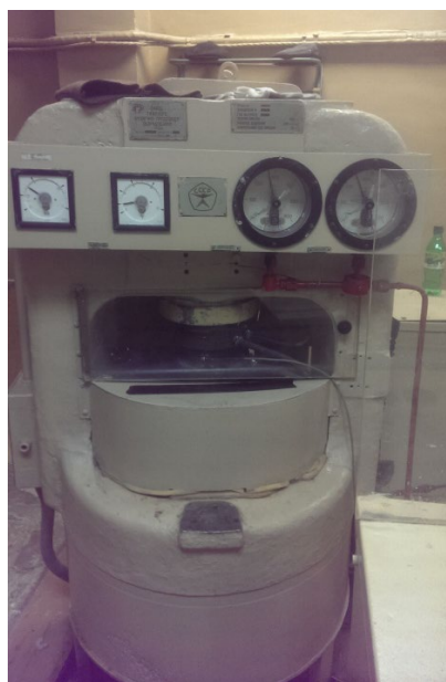
Рисунок 2.1 – Внешний вид гидравлического пресса ДО-137А
