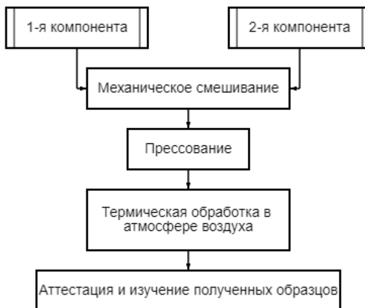
Рисунок 3.26 – Принципиальная схема получения керамического композита (1-x)\text{La}_{1,8}\text{Ca}_{0,2}\text{Ni}_{0,8}\text{Cu}_{0,2}\text{O}_{4+\delta}/(x)\text{SrTiO}_3 ( x = 0,01; 0,03; 0,07 )
