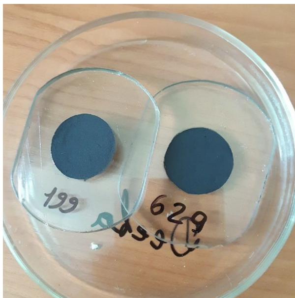
Рисунок 3.16 – Пробоподготовка образцов \text{La}_{1,8}\text{Ca}_{0,2}\text{Ni}_{0,8}\text{M}_{0,2}\text{O}_{4+\delta} (M = Co, Cu) после ТБО для РФА
