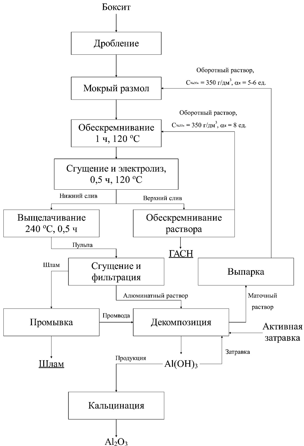
Рисунок 30 – Принципиальная технологическая схема переработки боксита с использованием электролитического восстановления железосодержащих минералов
