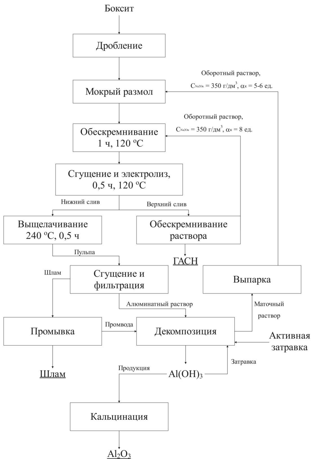
Рисунок 6.1 – Принципиальная технологическая схема переработки боксита с использованием электролитического восстановления минералов железа
