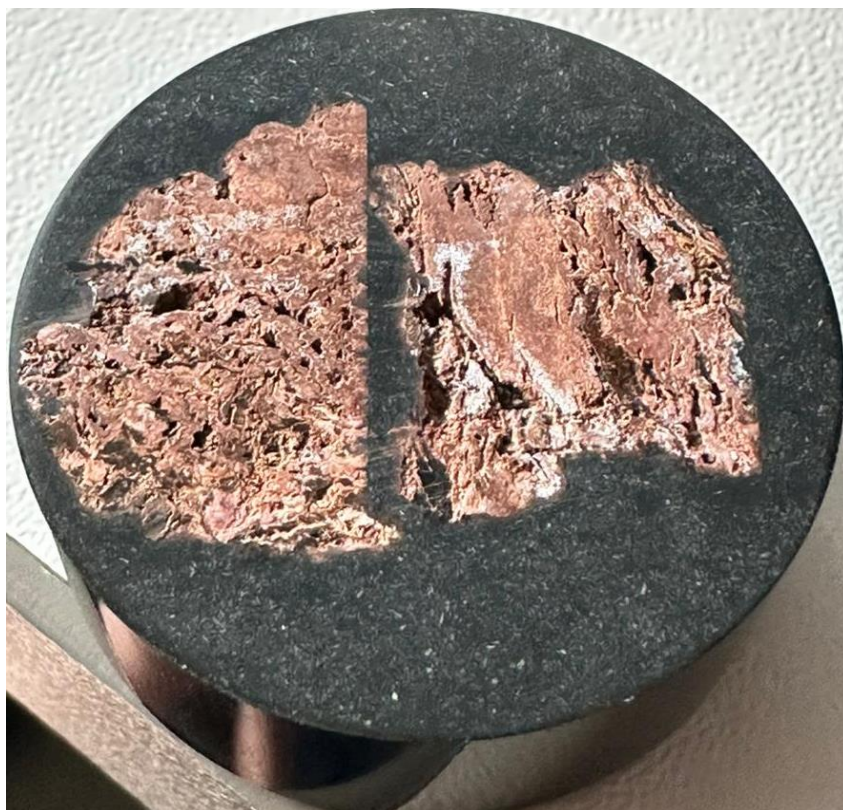
Рисунок 4.23 – Шлиф продольного и поперечного разреза образца боксита
