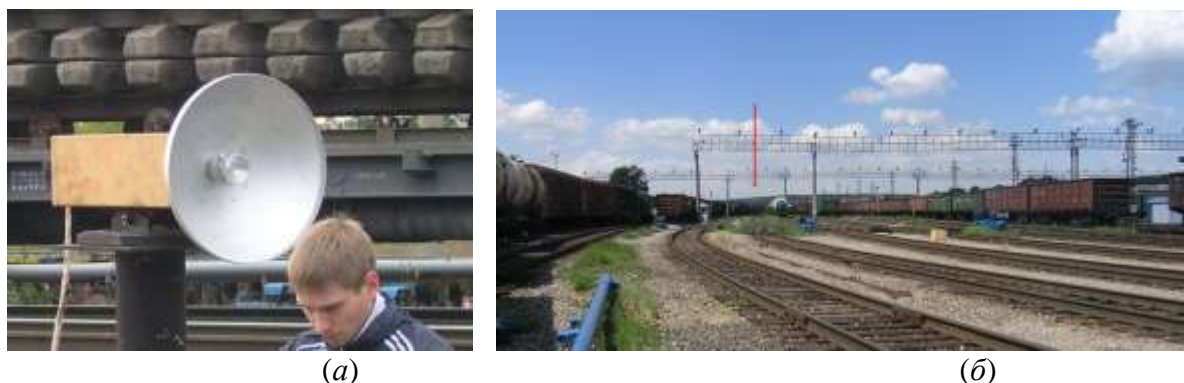
Рисунок 11. Внешний вид (а) автодинного радиолокатора и панорама (б) парка формирования (вертикальной стрелкой указан контролируемый путь).
