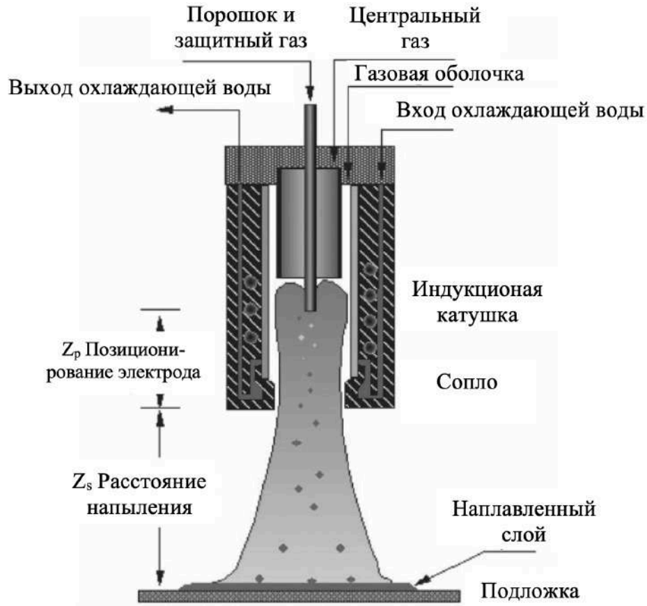
Рисунок 1.10 – Схема процесса плазменного напыления [83]
