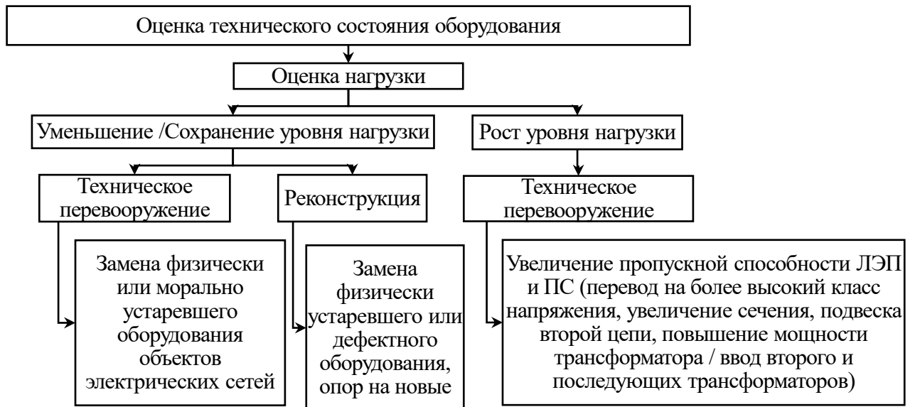
Рисунок 2.1 – Выбор мероприятий по ТПиР объекта электрических сетей и вида номенклатурных работ
