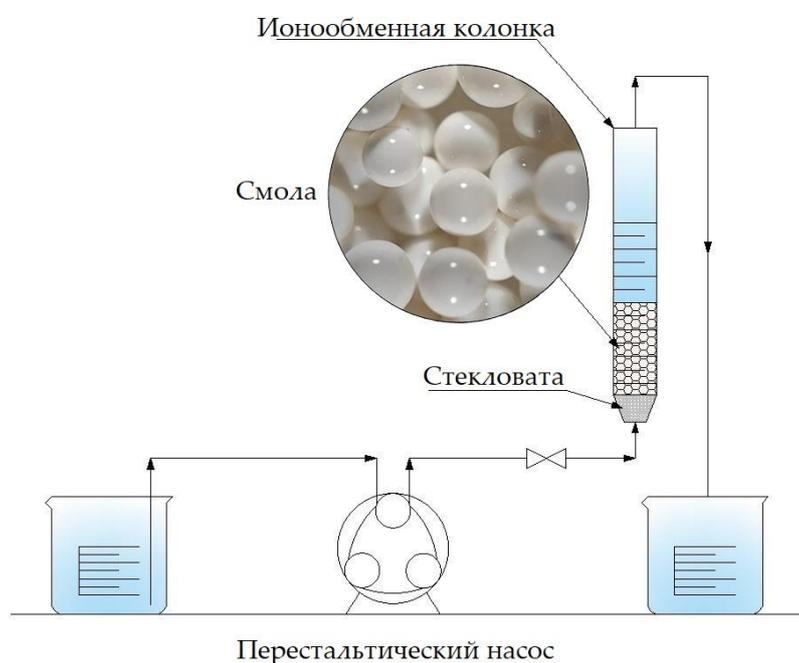
Рисунок 2.2– Схема лабораторной установки сорбции и десорбции РЗЭ в динамических условиях
