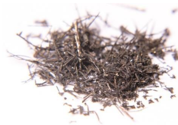
Рисунок 12 – Катодный металлический уран, полученный в ходе электролитического выделения урана при различных начальных катодных плотностях тока в электролите с концентрацией \text{UCl}_3 10,1 мас. %, температуре 550 °С, удельном количестве электричества 1 А·ч/см 2
