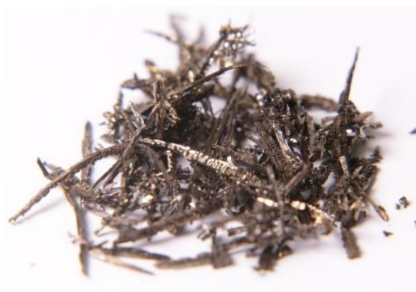
Рисунок 12 – Катодный металлический уран, полученный в ходе электролитического выделения урана при различных начальных катодных плотностях тока в электролите с концентрацией \text{UCl}_3 10,1 мас. %, температуре 550 °С, удельном количестве электричества 1 А·ч/см 2
