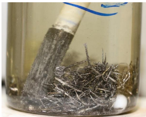
Рисунок 25 – Фотография процесса очистки катода от осадка урана
