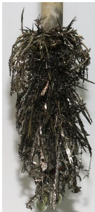
Рисунок 53 – Катодные осадки, полученные в ходе электролитического выделения урана при различных начальных плотностях катодного тока
