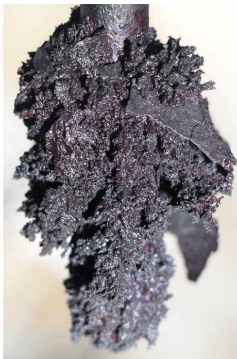
Рисунок 57 – Катодные осадки, полученные в ходе электролитического выделения урана при различных температурах, концентрации UCl_3 в электролите 10,1 мас. %, начальной катодной плотности тока 0,2 \text{ A/cm}^2 и удельном количестве пропущенного электричества 1,0 \text{ A}\cdot\text{ч/cm}^2
