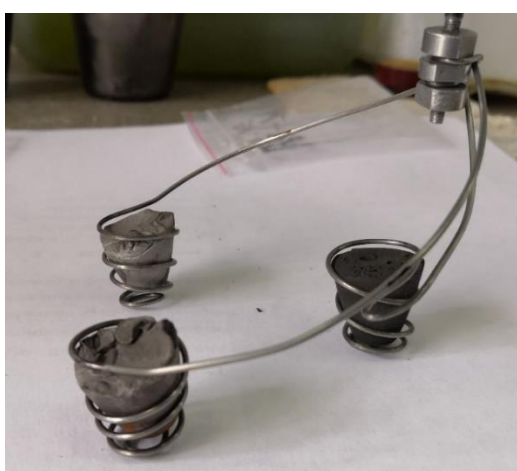
Рисунок 30 – Молибденовая корзина (тип 3) с загруженными образцами
