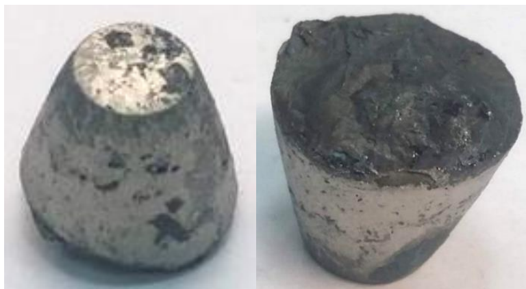
Рисунок 18 – Внешний вид полученного слитка U–Pd–Nd
