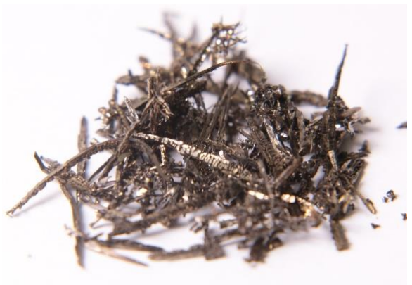
Рисунок 54 – Отмытый от электролита катодный металлический уран, полученный в ходе электролитического выделения урана при различных начальных плотностях катодного тока
