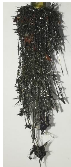
Рисунок 53 – Катодные осадки, полученные в ходе электролитического выделения урана при различных начальных плотностях катодного тока
