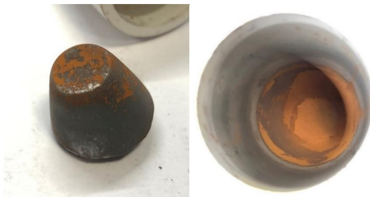
Рисунок 16 – Полученный слиток уранового сплава и вид внутренней поверхности тигля из оксида бериллия
