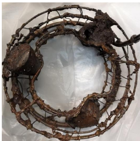
Рисунок 29 – Молибденовая корзина (тип 2) после проведенного эксперимента
