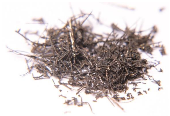
Рисунок 54 – Отмытый от электролита катодный металлический уран, полученный в ходе электролитического выделения урана при различных начальных плотностях катодного тока
