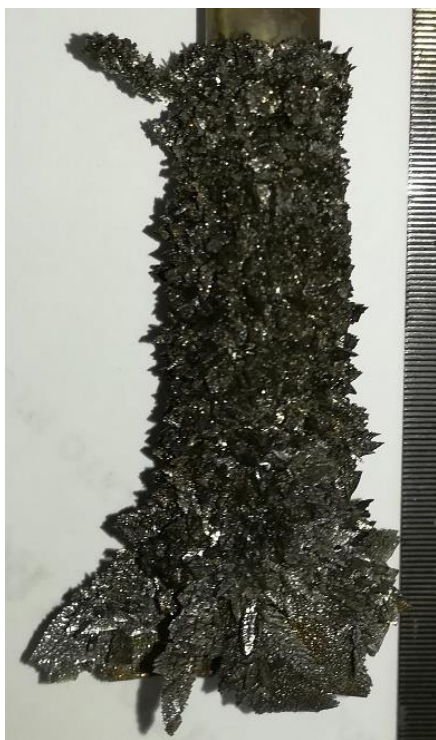
Рисунок 57 – Катодные осадки, полученные в ходе электролитического выделения урана при различных температурах, концентрации UCl_3 в электролите 10,1 мас. %, начальной катодной плотности тока 0,2 \text{ A/cm}^2 и удельном количестве пропущенного электричества 1,0 \text{ A}\cdot\text{ч/cm}^2
