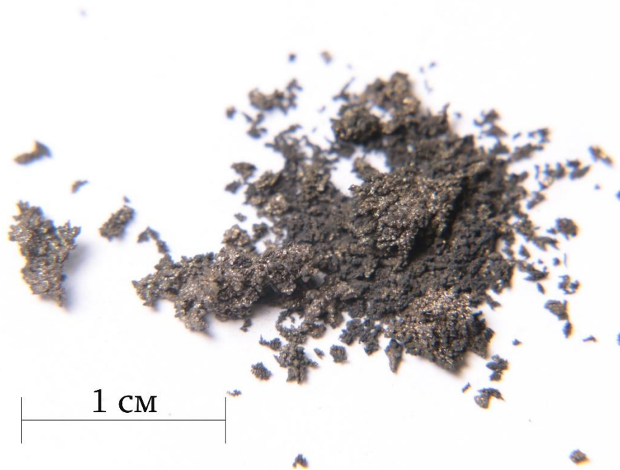
Рисунок 58 – Отмытый от электролита катодный осадок урана, полученный в ходе при температуре 720 \text{ °C} , концентрации UCl_3 в электролите 10,1 мас. %, начальной катодной плотности тока 0,2 \text{ A/cm}^2 и удельном количестве пропущенного электричества 1,0 \text{ A}\cdot\text{ч/cm}^2
