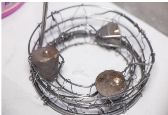
Рисунок 28 – Молибденовая корзина (тип 2) с загруженными образцами
