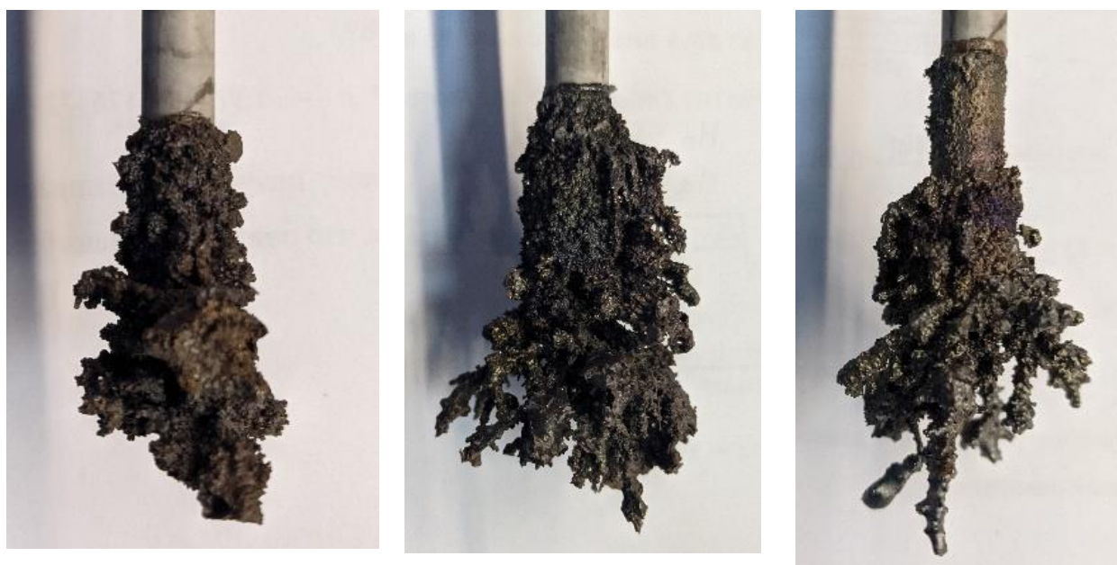
Рисунок 64 – Катодные осадки, полученные в ходе электролитической переработки МОЯТ при варьировании начальной катодной плотности тока
