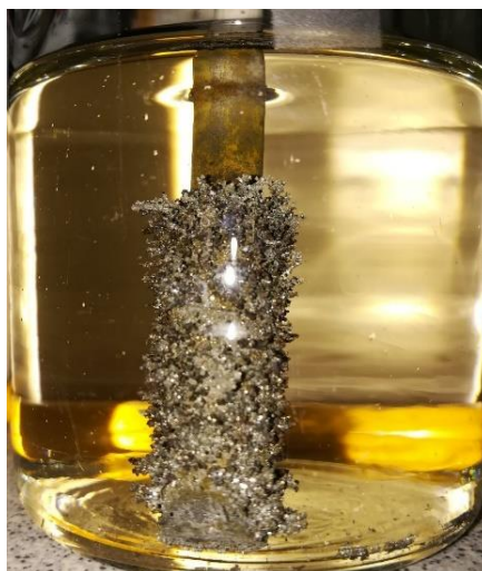
Рисунок 24 – Катод с осадком урана, помещенный в раствор азотной кислоты
