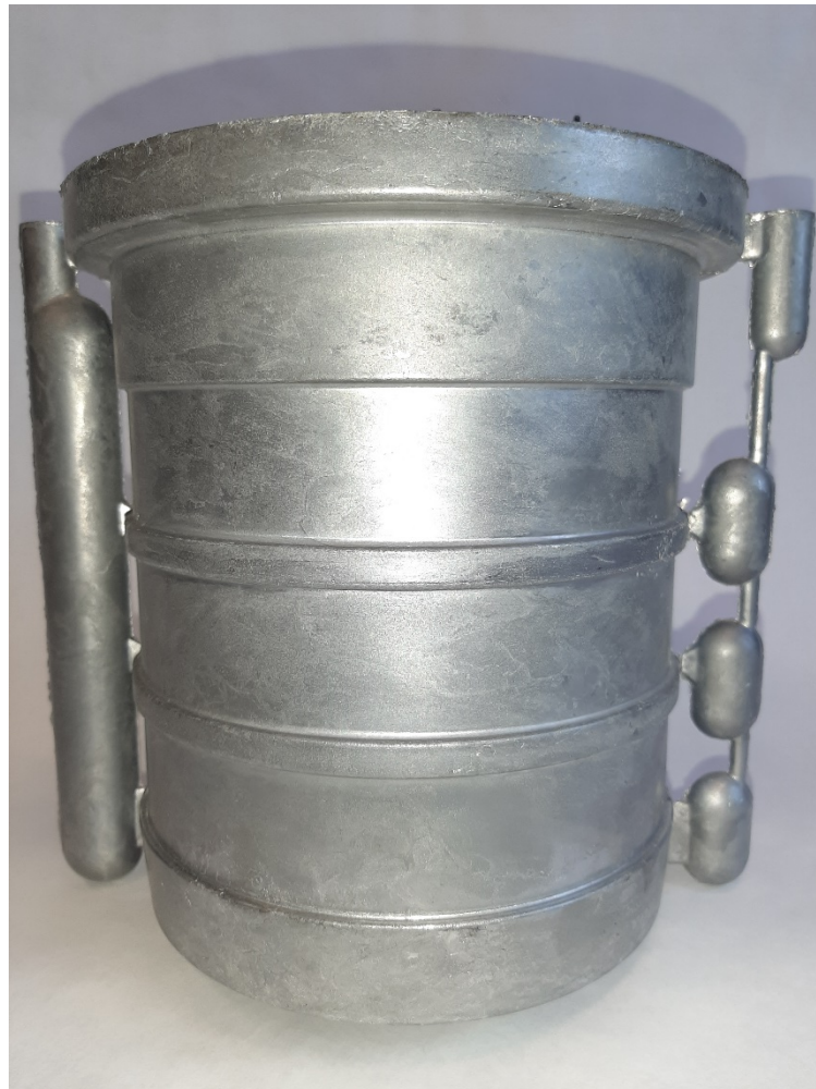
Рисунок 3.26 – Отливка «Головка соединительная рукавная напорная ГР–150» из композита
