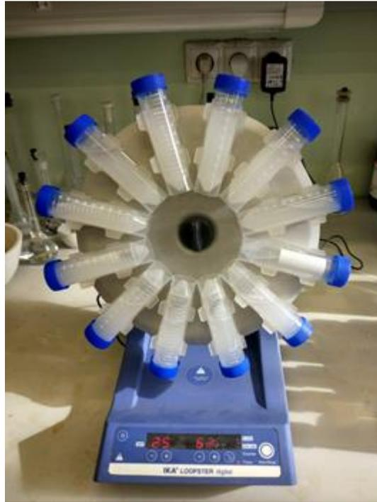
Рисунок 4– Установка для определения статической ёмкости ионитов и ТВЭКСов
