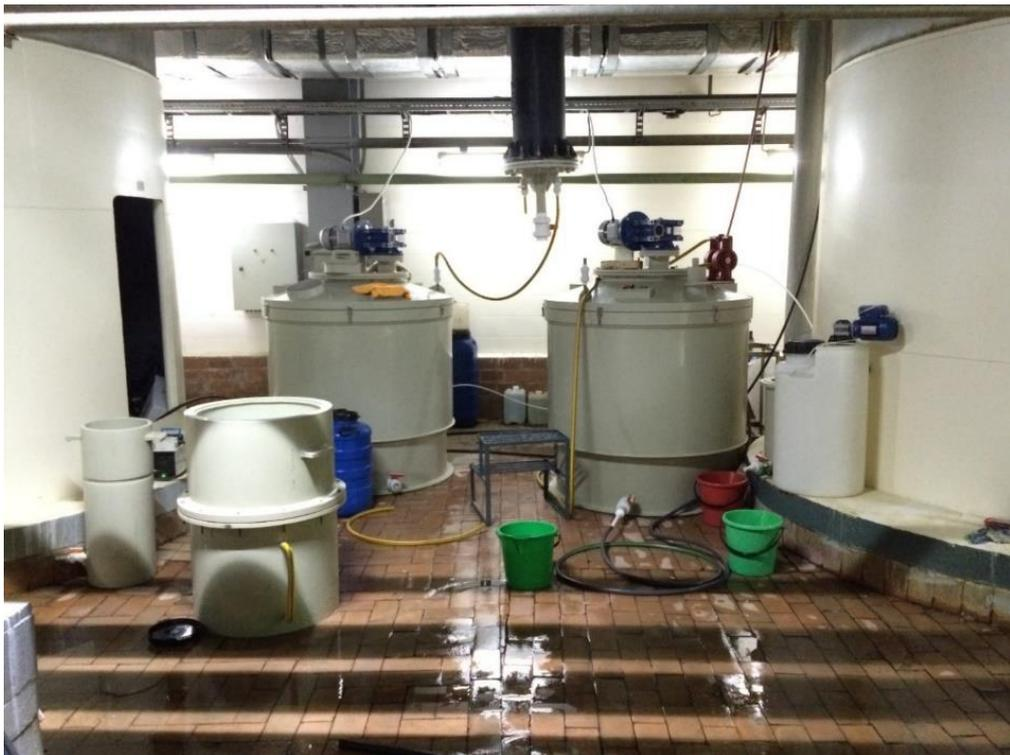
Рисунок 71 – Вид исследовательской установки извлечения Sc из растворов ПВ урана
