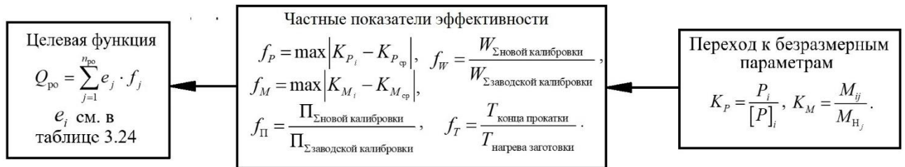
Рисунок 3.21 – Блок-схема расчета значения целевой функции критерия оптимальности режима обжатый
