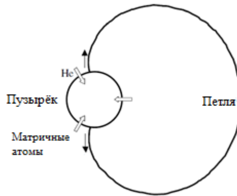
Рисунок 1.10 – Схематическое представление взаимодействия комплекса пузырьков – дислокационная петля [59]
