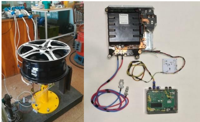
Рисунок 18 - Макетный образец мотор-колеса и испытательный коммутатор
