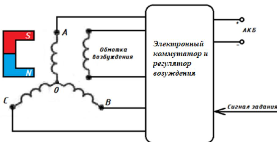
Рисунок 1.2.2 - Схема подключения обмоток
