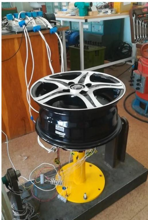
Рисунок 5.1.12 - Макетный образец мотор-колеса в сборе
