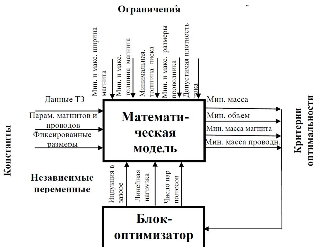
Рисунок 2.4.1. - Блок-схема задачи однокритериальной оптимизации
