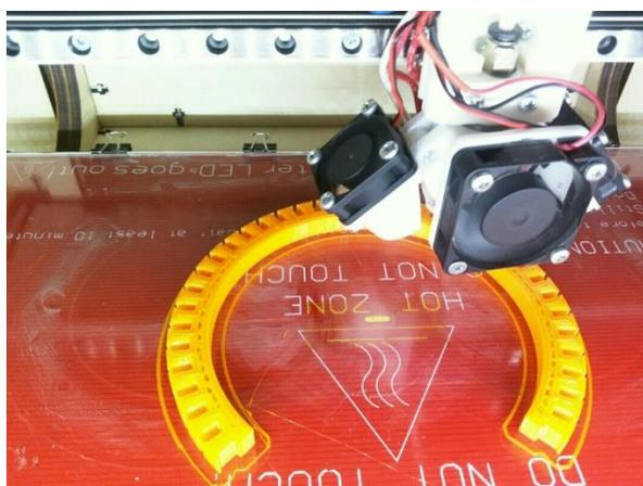
Рисунок 5.1.8 - Процесс печати деталей макетного образца мотор-колеса
