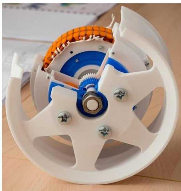
Рисунок 5.1.9 - Макетный образец мотор-колеса в масштабе 1:2
