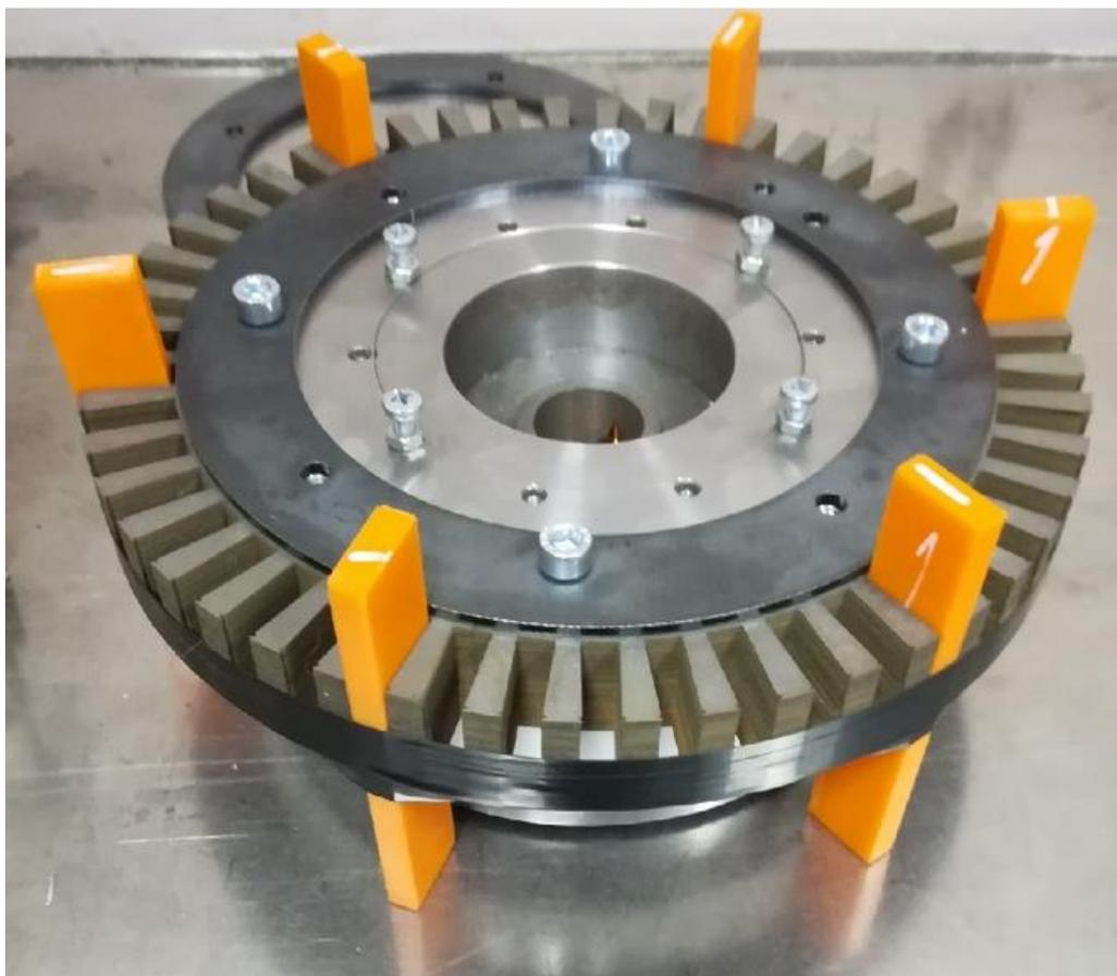
Рисунок 5.1.10 - Процесс сборки пакетов статора
