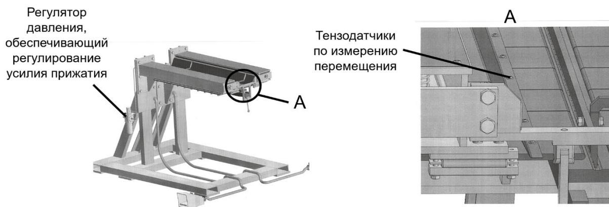
Рисунок 15 – Приспособление, спроектированное по предложенной методике
