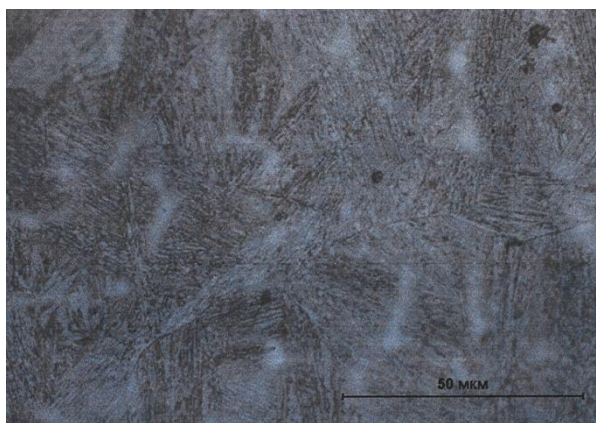
Рисунок 3.8 – Микроструктура сварного шва образца №1
