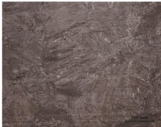
Рисунок 3.12 – Микроструктура участка перегрева образца №4
