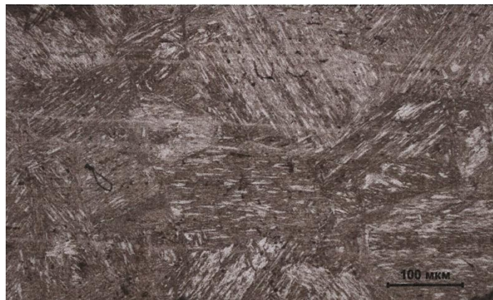
Рисунок 3.15 – Микроструктура участка перегрева образца №7
