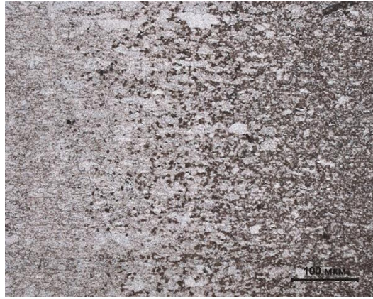
Рисунок 3.16 – Микроструктура участка неполной рекристаллизации сварного соединения образца №7
