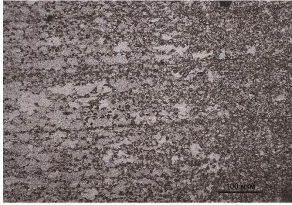
Рисунок 3.10 – Микроструктура участка неполной рекристаллизации образца №1
