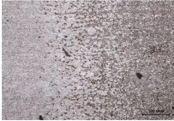
Рисунок 3.13 – Микроструктура участка неполной рекристаллизации образца №4
