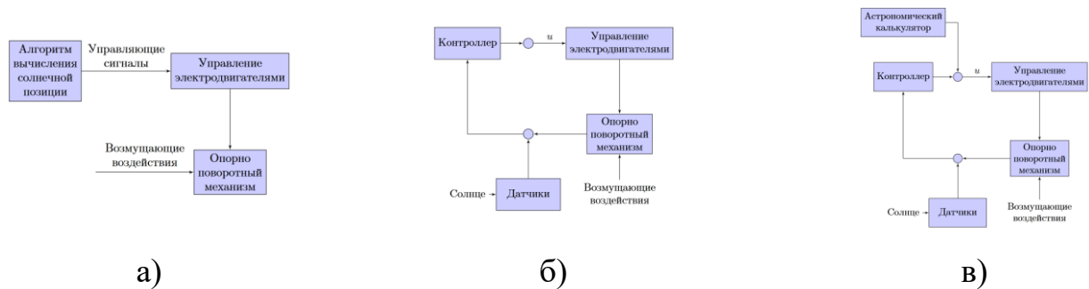
Рисунок 1.7 – Схема системы открытого цикла (а), закрытого цикла (б) и комбинированного цикла (в)
