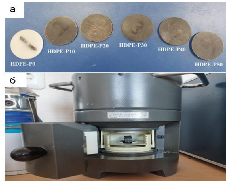
Рисунок 5.2. а –изготовленные образцы , б– экспериментальная установка для измерения коэффициента линейного ослабления
