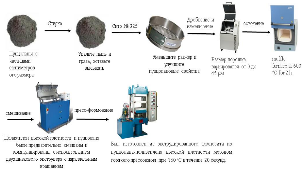
Рисунок 5.1. Схема изготовления коммерческого композита PZ-HDPE
