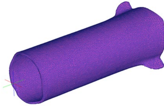
Рисунок 3.4 – Типовая сетка КЭ трубной заготовки
