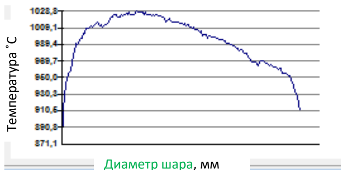
Рисунок 4.3 - Распределение температуры по поверхности шара Ø100 после стана
