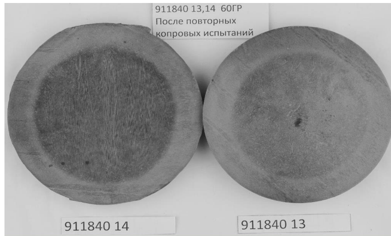
Рисунок 4.16 - Макроструктура шаров диаметром 100 мм из стали марки 60ГР
