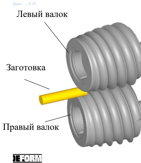
Рисунок 2.4 – Позиционирование прокатных валков и заготовки
