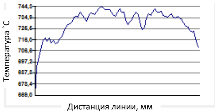
Рисунок 4.4 - Распределение температуры по поверхности шара \varnothing 100 перед закалкой
