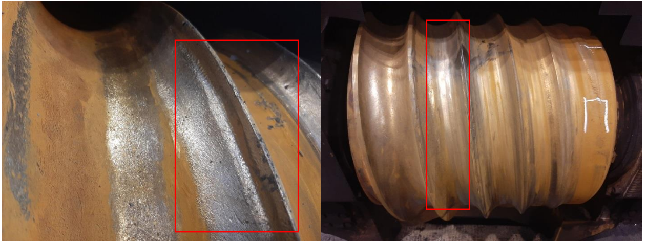
Рисунок 1.6 – Прокатные валки с износом на участке разрыва перемычки между шарами.
