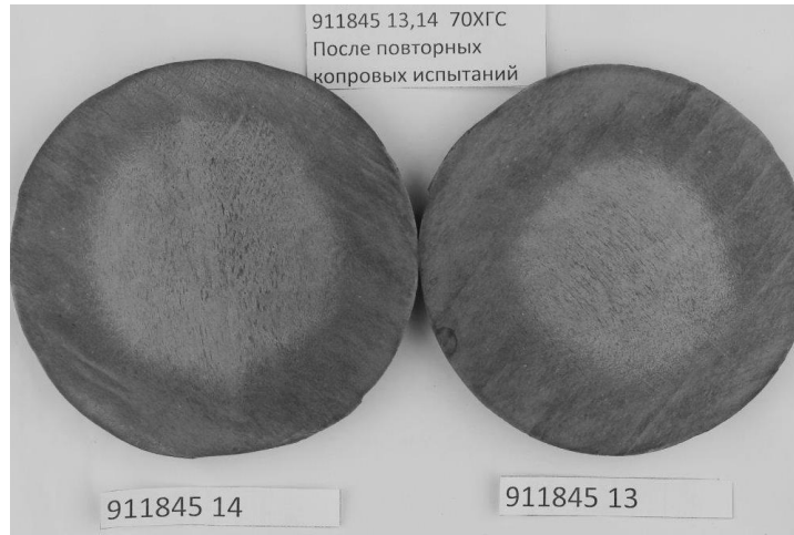
Рисунок 4.20 - Макроструктура шаров диаметром 100 мм из стали марки стали 70ХГС
