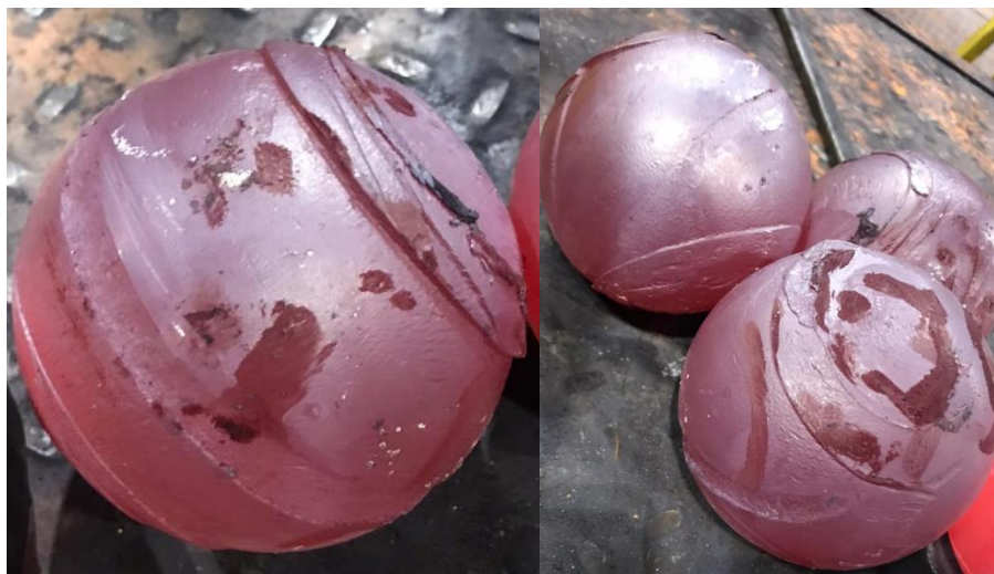
Рисунок 1.8 – Мелющие шары диаметром 100 мм при износе реборд валков.
