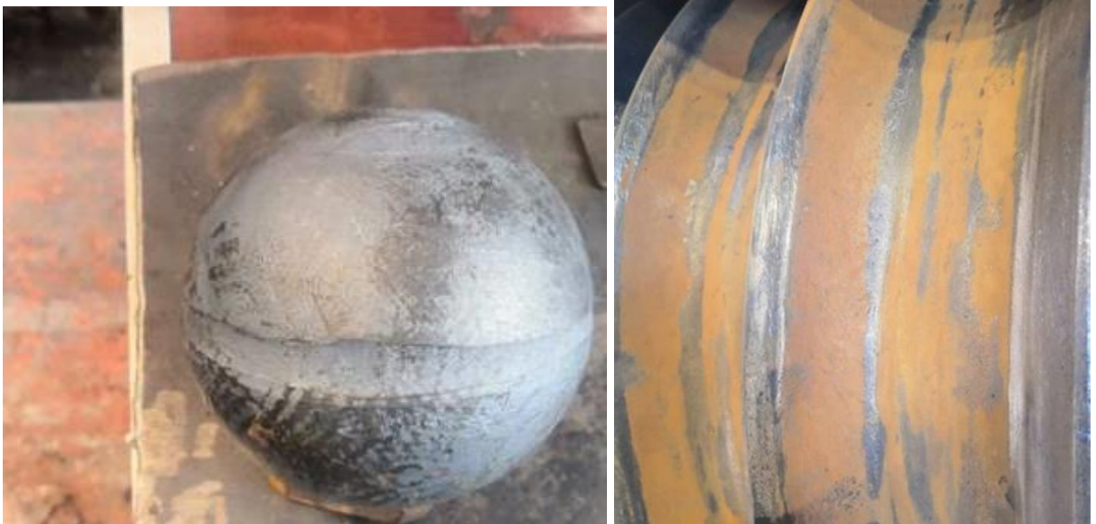
Рисунок 2.23 - Фотография шара и состояние рабочей реборды при новой калибровке и настройках стана
