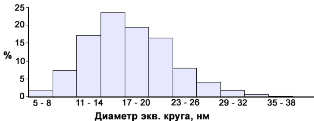
Рисунок 3.8 – Гистограмма распределения кристаллитов по размеру в сплаве \text{Fe}_{72.5}\text{Cu}_1\text{Nb}_2\text{Mo}_{1.5}\text{Si}_{14}\text{V}_9 после отжига при 550^\circ\text{C}
