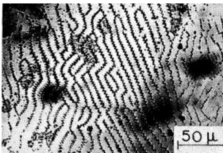
Рисунок 1.3 – Магнитные домены, обнаруженные на поверхности аморфизованного Fe_{80}P_{13}C_7 сплава. Приложено магнитное поле около 8000 А/м перпендикулярно к поверхности образца [26]
