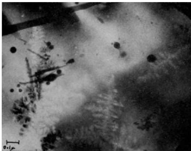
Рисунок 1.1 – Электронная микроскопия частично кристаллизованного \text{Te}_{85}\text{Ge}_{15} , показывающая дендритные области внутри аморфной матрицы [18]
