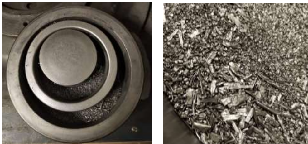
а – круговая мельница; б – полученный порошок
