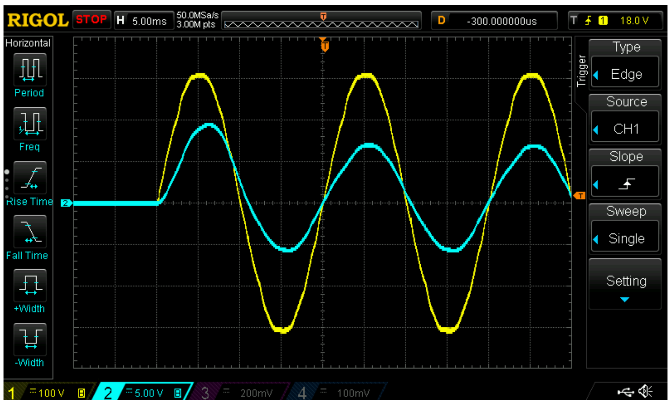
Рисунок 4.9 – Осциллограммы включения электродвигателя 500 Вт (канал коммутации 1 сверху, канал коммутации 2 снизу)
