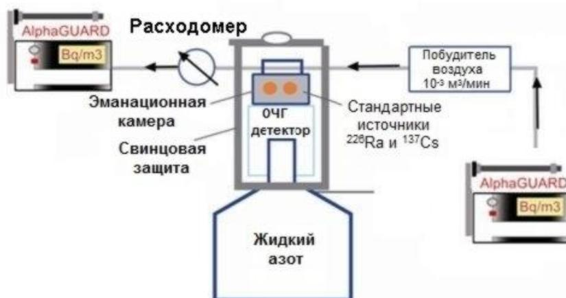
Рис. 2. Схема средства воспроизведения единицы объемной активности радона, работающего в проточном режиме
