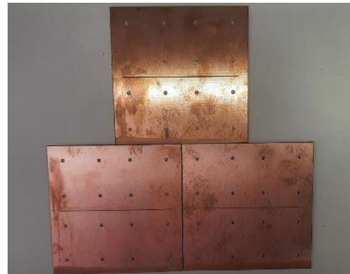
Рисунок 8 – Фотографии макетов печатных плат с: а) полосковыми резонаторами, б) щелевыми резонаторами разной ширины (0,35 мм, 0,7 мм, 1 мм)
