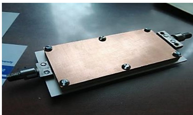
Рисунок 4 – Фотографии макета многослойного полосково-щелевого перехода с симметричными полосковыми линиями
