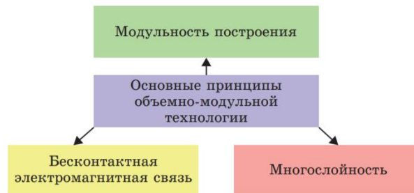
Рисунок 1.6 – Основные принципы объемно-модульной технологии
