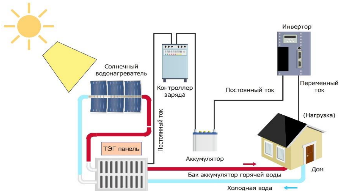
Рис. 6. Схема система ТЭГ (с использованием двухслойного теплообменника)
