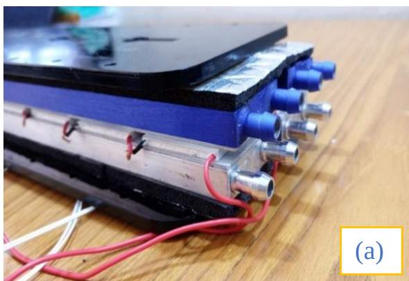
Рис. 7. Экспериментальная реализация разработанной ТЭГ панели: (а) вид сбоку, показывающий различные слои панели, (b) подключение к микроконтроллеру Arduino Mega и измерительным устройствам
