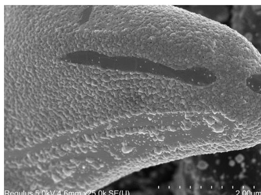
Рисунок Б.3.3 - Фотография с изображением металлических частиц вольфрама с разрешением 2  $\mu\text{m}$  на графитовой поверхности печи после термической обработки вольфрамом натрия. Сканирующая электронная микроскопия
