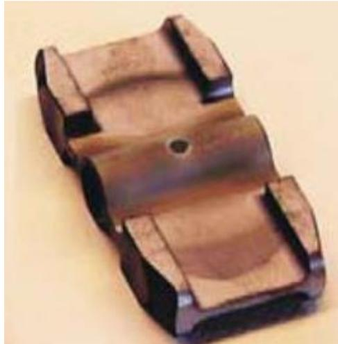
Рисунок В.1.1 – Графитовый коммерческий электротермический атомизатор: печь Массманна поперечного нагрева с интегральной платформой для спектрометра атомно-абсорбционного модели contrAA® 700, «Analitik Jena AG», Йена, Германия (вид сверху)
