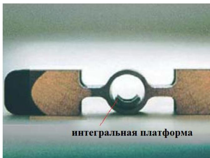
Рисунок Б.1.2 – Графитовый коммерческий электротермический атомизатор: печь Массманна поперечного нагрева с интегральной платформой для спектрометра атомно-абсорбционного модели contrAA® 700, «Analitik Jena AG», Йена, Германия (вид сбоку)
