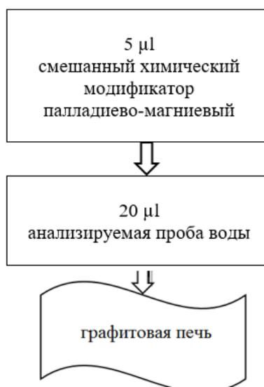
Рисунок 4 – Автоматическая подача пробы и химического модификатора в систему
