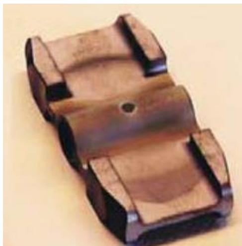
Рисунок Б.1.1 – Графитовый коммерческий электротермический атомизатор: печь Массманна поперечного нагрева с интегральной платформой для спектрометра атомно-абсорбционного модели contrAA® 700, «Analitik Jena AG», Йена, Германия (вид сверху)
