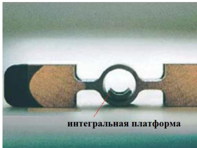
Рисунок В.1.2 – Графитовый коммерческий электротермический атомизатор: печь Массманна поперечного нагрева с интегральной платформой для спектрометра атомно-абсорбционного модели contrAA® 700, «Analitik Jena AG», Йена, Германия (вид сбоку)
